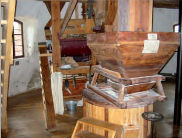
Die Technik der Kornmühle entspricht einer typischen Handwerksmühle von etwa 1930. Sie ist voll funktionstüchtig und konnte früher ca. 1,5 Tonnen Getreide verarbeiten. In der frei drehbaren, 25 Tonnen schweren Turmhaube, kann man die mächtige Flügelwelle und ein 3,20 m großes Kamrad zur Übertragung der Windkraft bestaunen. Beides ist aus einheimischen Hölzern gezimmert. Sollte ausreichend Wind vorhanden sein, drehen sich die Flügel.
